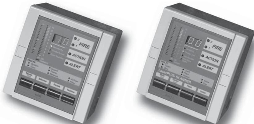
Os módulos do Display fornecem informações em tempo real sobre o estatus do detector VESDA. Eles apresentam um gráfico de barras verticais de 20 segmentos, Display numérico de 2 dígitos e aviso sonoro, indicadores claros de alarme e falha. Eles também contam com 4 teclas para controlar o detector e o modo do Display.
